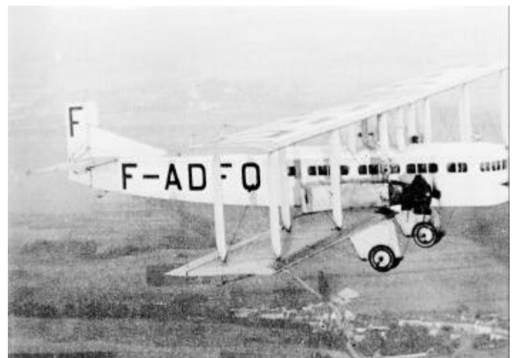
Farman Goliath F-60 n° 42 utilisé sur Paris Londres en 1920 modifié en F-161 (moteurs Jupiter remplaçant les Renault). (Cliché Musée de l'Air).
